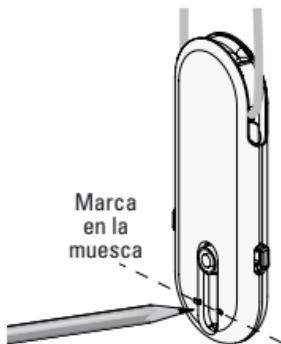
4. Sujete el soporte IB con el orificio central alineado con la marca y marque la posición de ambos orificios.
